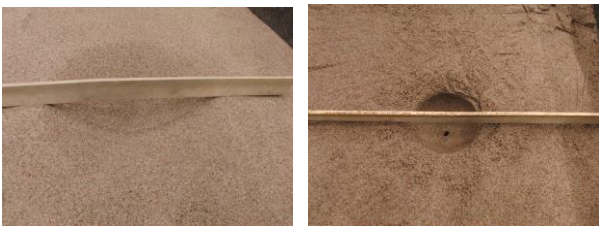
Kuva 7. HIC –testauksessa mittapään kolmannen pudotuksen jälkeinen mittausjälki ( \phi 160 mm) materiaalin ollessa kuivaa (vasemmalla) ja märkää (oikealla).
