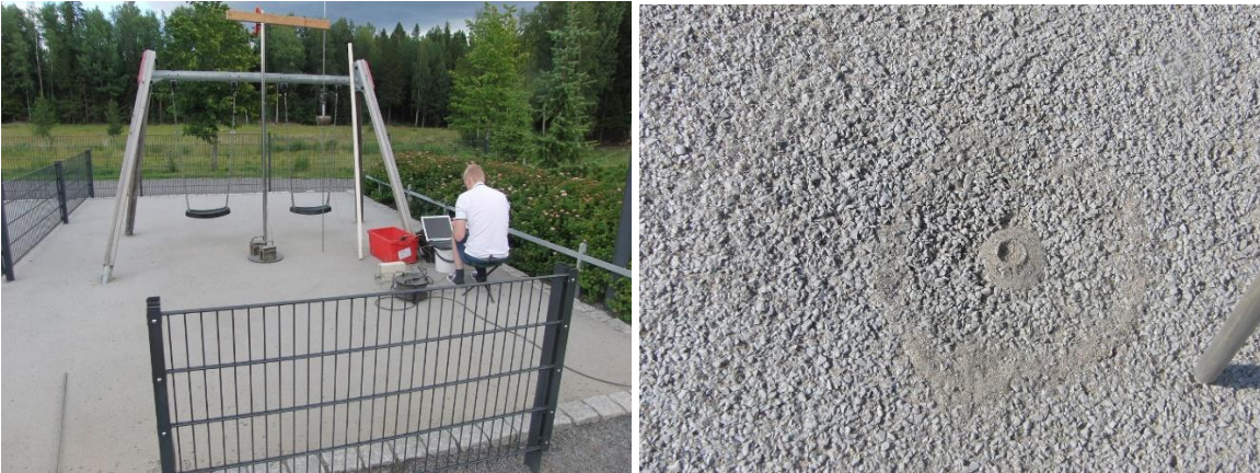
Kuva 4. Mineraalinen hienoaines (oikealla) valetun kumialustan huokosrakenteessa.
