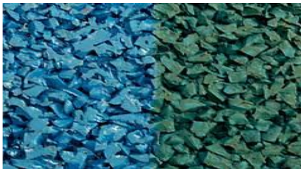
Kuva 1. Vasemmalla alkuperäinen sininen EPDM ja oikealla värjäntynyt (Berleburger n.d.).
