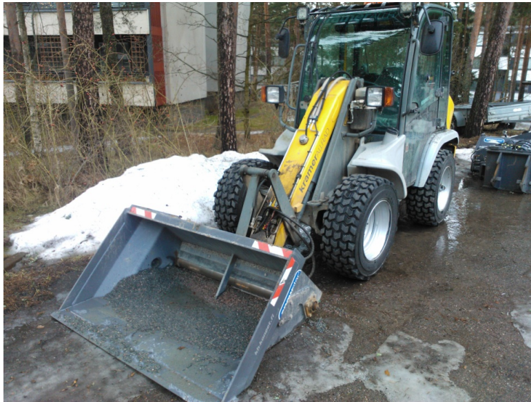
Kuva 3. Kiinteistötraktori, kauhassa kiinteä tasareunainen metalliterä.
